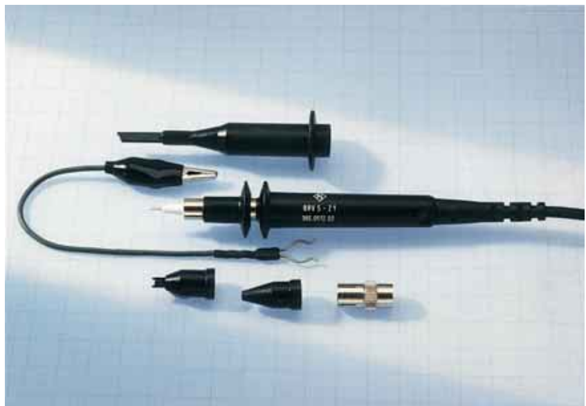
DC-Tastkopf R&S® URV5-Z1, 1 mV bis 400 V, 3 pF // 9 M \Omega
